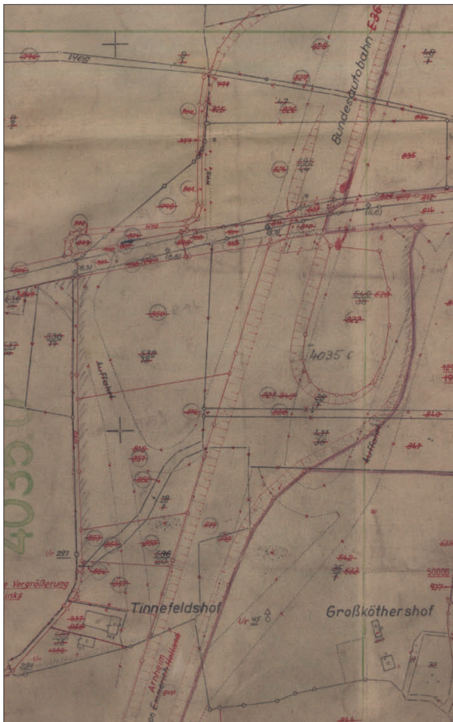
Ausschnitt Katasteramtskarte 1952 mit Fortführungen in rot. Gemarkung Hamminkeln, Flur 3, Maßstab 1:1000 verkleinert mit der Lage des Tinnefeldshofes . Die gestrichelte Linie entspricht der Vorkriegsplanung der Reichsautobahn.
