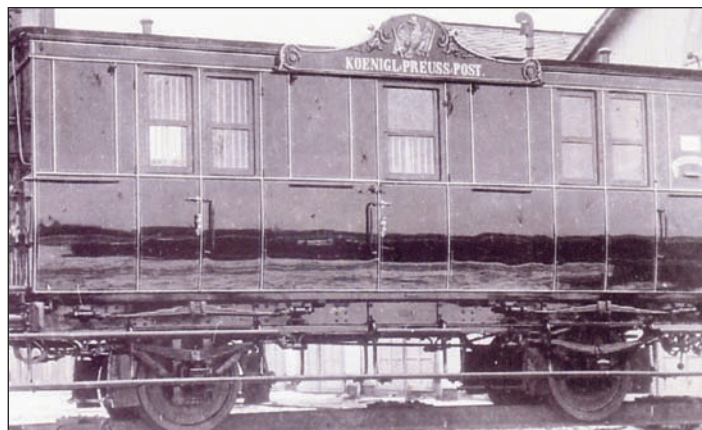
Fotosammlung: E.H. Zweiachsiger preußischer Bahnpostwagen mit einer Länge von 6,90 Metern. Das Innere des um 1860 geabuten Wagens ist in einen Brief- und Packraum unterteilt.
